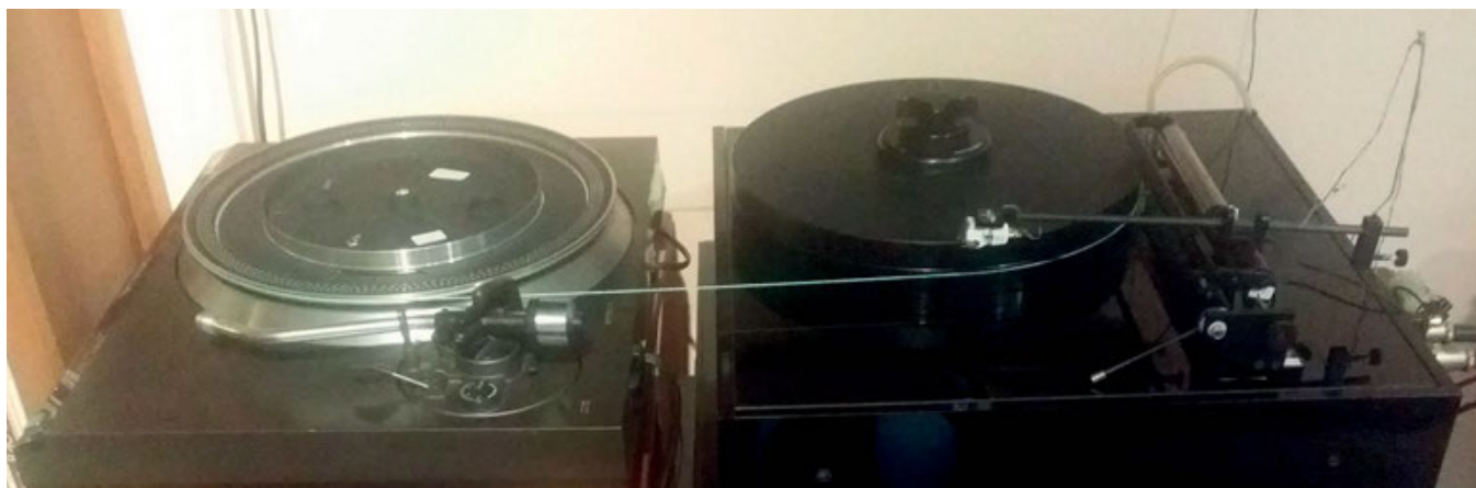
Un filo di lana agisce da cinghia di trasmissione tra una enorme puleggia costituita dal piatto (rovesciato) di un giradischi Technics a trazione diretta e il piatto di un giradischi Forsell, modificato da Torlai e che funge da sistema di lettura.
