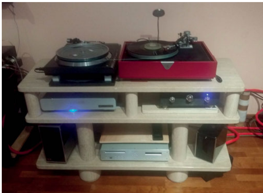
Uno dei sistemi di lettura realizzati da Torlai accoppiando due giradischi, dei quali uno funge da motore (Technics a trazione diretta) e l'altro da sistema di lettura. Notare il solido piano di appoggio in marmo travertino.
