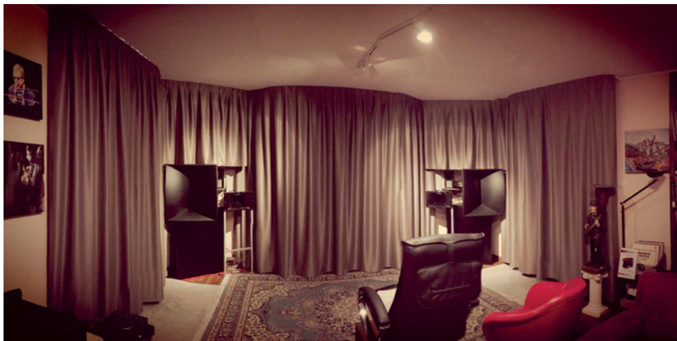
La sala d'ascolto principale con, negli angoli, efficientissimi diffusori di derivazione Klipschorn. Le pareti sono rivestite con tende di media pesantezza mentre la poltrona è nella posizione d'ascolto ottimale.
